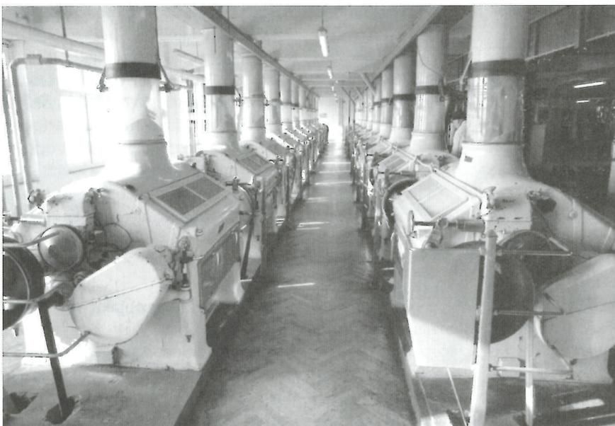
Abb. 1: Typischer Walzenboden einer Getreidemühle.
